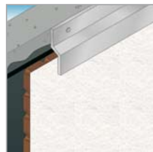
Fijación con perfil metálico superior. Longitudinal fixing with a metallic profile. Fixations avec un support métallique supérieur. Fixação com o perfil metálico superior.
