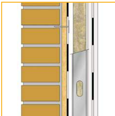
Tabiquería mixta. Mixed dry wall. Cloison mixte. Alvenaria mista.
